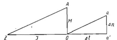
Nun tragen wir auf der negativen Abszissenachse von Bild 1 mit dem errechneten Maßstab das Trägheitsmoment des Motors ab und erhalten den Punkt  $Z$ .
