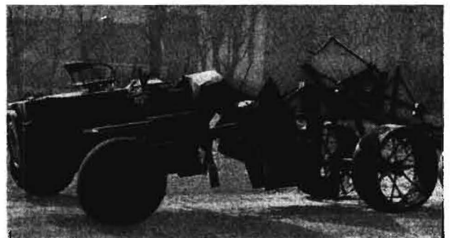
Bild 9. Das Holzendorfer Verteilergerät wird gemeinsam mit dem Grabenpflug von der Seilwinde gezogen. Auf jeder Seite des Grabens arbeitet ein Schleuderstern, der aus je drei Messern und drei Schaufeln besteht
