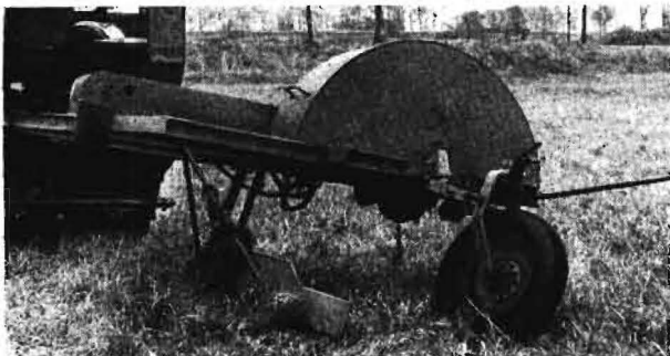
Bild 8. Das Protzener Aushubschneidegerät ist so am Schlepper befestigt, daß der Grabenaushub zwischen dem rechten Hinterrad des Schleppers und dem Stützrad des Gerätes liegt. Die von der Zapfwelle mittels Kettenübersetzung angetriebenen Schneidmesser sind hier wegen Beschädigung des Gerätes demontiert. Ihre Größe und Anbringung ist aus der Form der Schutzverkleidung zu ersehen
