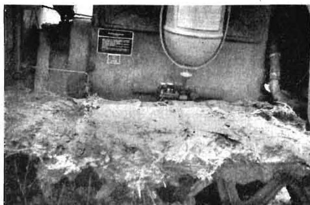
Bild 2. Verschmierte Kette beim Arbeiten auf Lehm mit zu großem Feuchtigkeitsgehalt
