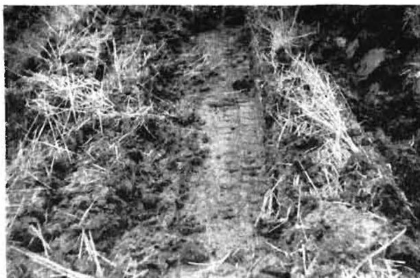
Bild 1. Fahrspur einer Kette bei zu großem Schlupf
