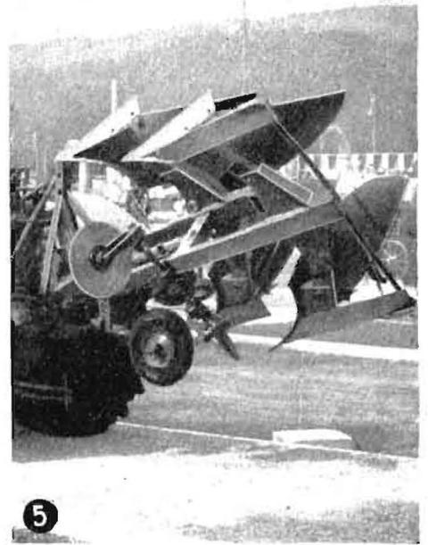
bunden. Er wird durch Anbremsen des gleichen Räderpaares (wie der Raupenschlepper) gelenkt. Seine Leistungen bei einem Arbeitsversuch im Forst (Sumpfgelände an Hängen) setzten die Besucher in Erstaunen.
