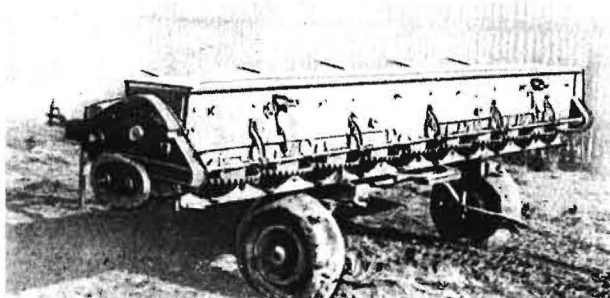
Bild 9. Großflächenstreuer „Melotte“, Belgien, 3,80 m Arbeitsbreite. Er arbeitet nach dem bekannten Tellersystem
