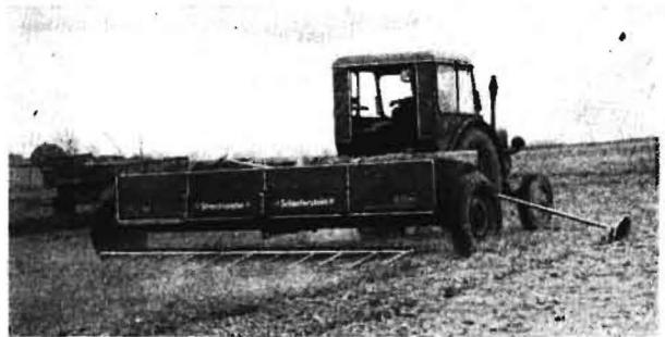
Bild 7. Großflächenstreuer „Streumeister“ von SCHIEFERSTEIN, 4 m Arbeitsbreite, ein Gitterstreuer
