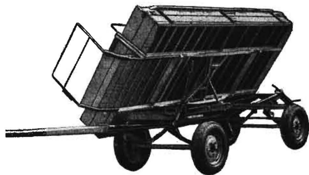
Bild 2. 2-t-Gespannwagen mit Kippvorrichtung, Typ K 40
