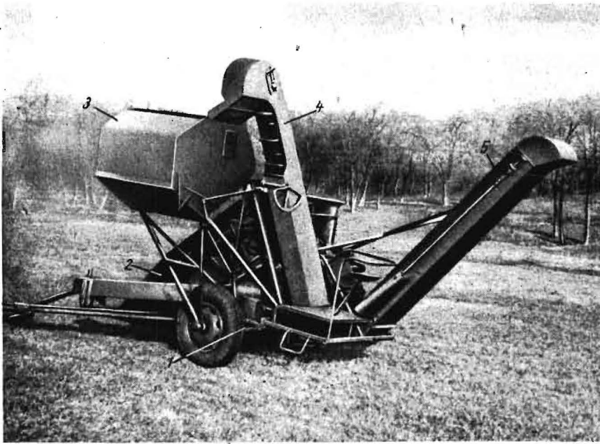
Bild 13. Maisvollerntemaschine KAS-2, Länge 6,2 m, Breite 4 m, Höhe 3,5 m, Gewicht 2100 kg, Spurweite 2,2 m. 1 Fahrwerk, 2 Schneidwerk, 3 Kolbenbehälter, 4 Kolbenförderer, 5 Häckselförderer
