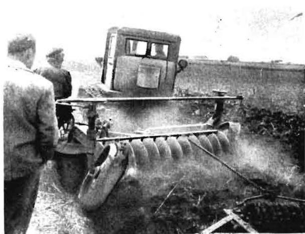
Bild 2. Scheibenege ET bei der Arbeit
