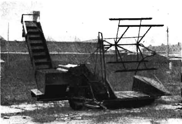
Bild 1. Der umgebaute Lanz-Binder als Mähhäcksler (MTS-Spezialwerkstatt Oschersleben)
