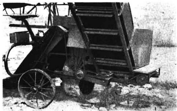
Bild 3. Antrieb der Häckseltrommel und des Förderbandes. Zugvorrichtung am Hauptrahmen befestigt
