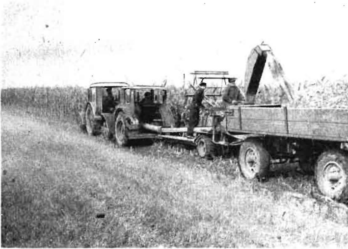
Bild 4 (oben). Der hohe Zugkraftbedarf des Mähhäckslers E 065 erforderte bei etwas Bodenfeuchtigkeit oft zwei Schlepper als Zugkraft
