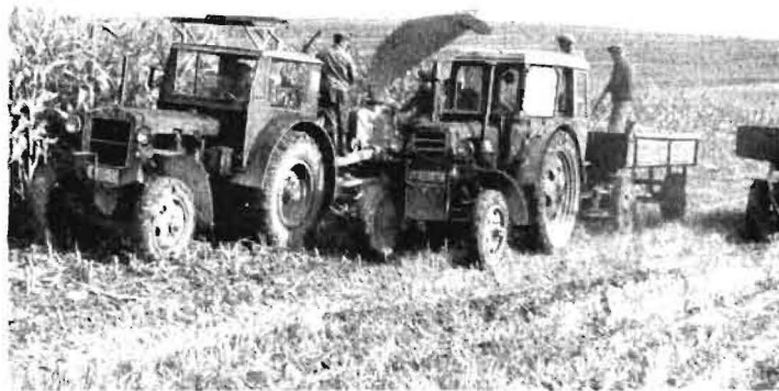
Bild 5. Nebenherfahren des Anhängers verringerte den Zugkraftbedarf und ermöglichte das Einsparen der Umhängezeiten
