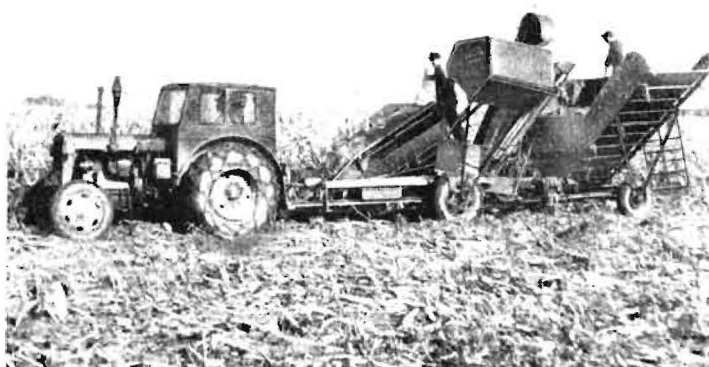
Bild 6. Voraussetzung für den Einsatz ist eine Reihenweite von 62,5 cm
