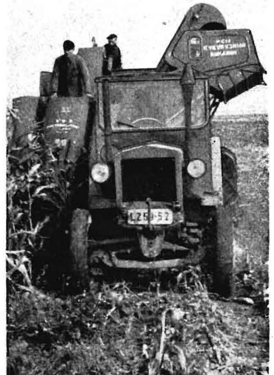
Bild 4 (oben). Der hohe Zugkraftbedarf des Mähhäckslers E 065 erforderte bei etwas Bodenfeuchtigkeit oft zwei Schlepper als Zugkraft
