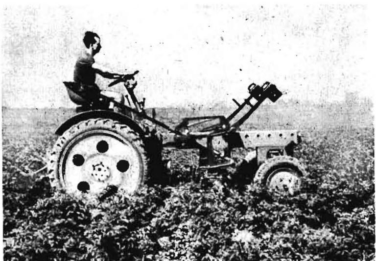
Bild 2. Anbauvielfachgerät P 320 am Geräteträger RS 09
