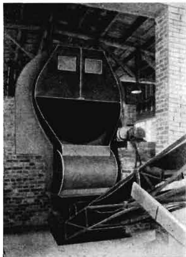
Bild 1. Trommeltrockner QTe (Pillnitz), Auslaufseite mit Austragschleuse, Tür geöffnet [NAGEMA, Dresden]
