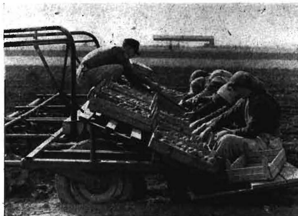
Bild 3. Rübenverziehkarren mit Einrichtung zum Legen vorgekeimter Kartoffeln
