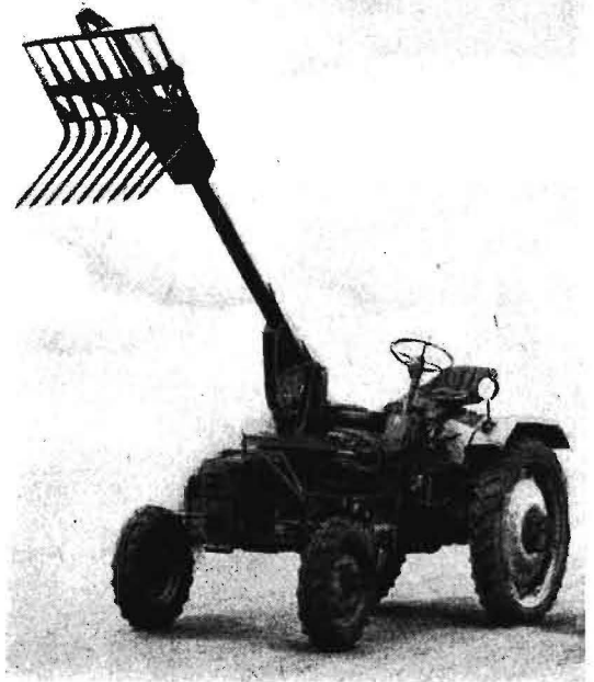
Bild 14. RS 09 mit Kombi-Ladebaum als Dunggabel ausgerüstet
