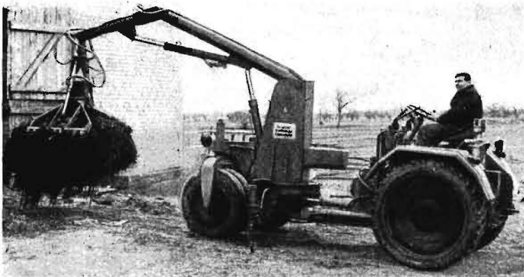
Bild 15. Die RS 09 Triebachse mit hydraulischem Schwenkkran T 157
