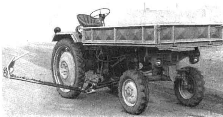
Bild 8. RS 09 mit Anbau-Mähbalken E 143 in Putzstellung und Ladepritsche
