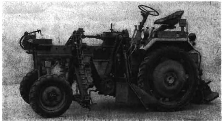
▼ Bild 11. RS 09 mit Anbau-Grabenfräse
