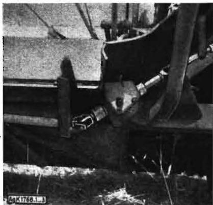
Bild 1. Kraftübertragung durch Kreuzgelenk und Querwelle
