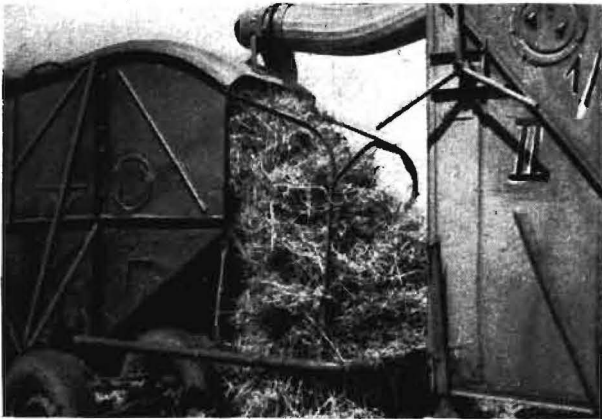
Bild 8. Der Strohauslauf setzt sich bei großen Hocken zu
