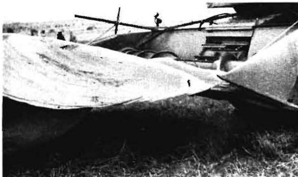
Bild 6. Der Wind wirft die leere Plane hoch und in die Einzugschwelle
