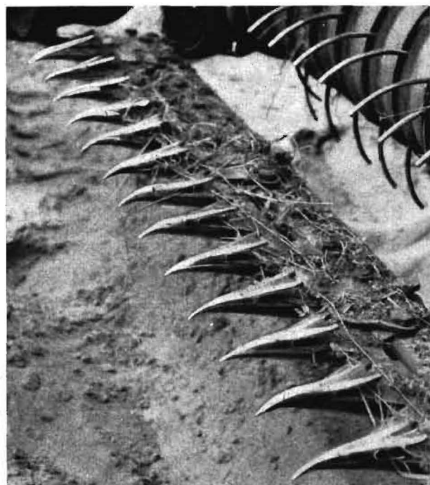
Bild 2. Nach unten umgebogene Finger des Schneidwerks ▼
