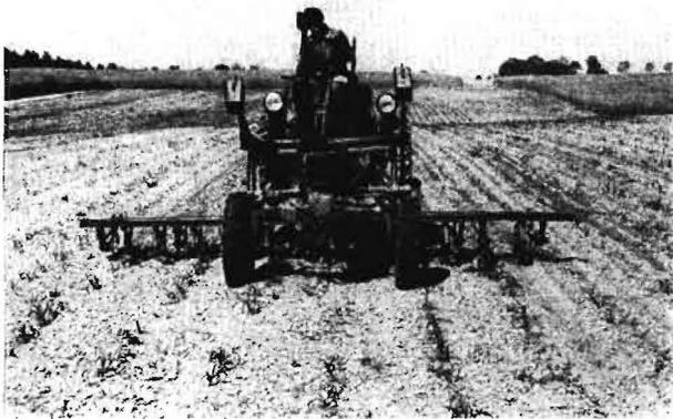
Bild 7. Anbau-Vielfachgerät P 181 mit verbreitertem Werkzeugträger
