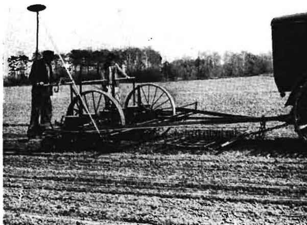
Bild 1. Maislegemaschine SKG(K)-6 W
