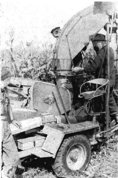
Bild 1 Zur Beseitigung einer Verstopfung des Mähhäckslers E 065/1 wird die Maschine stillgesetzt und der Schutz abgenommen
