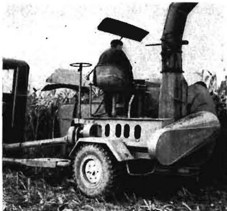
Bild 1. Der neue tschechoslowakische Mähhäcksler SRZ-138 für Traktorzug von Agrostroj Pelhrimov (alle Fotos: J. KOHOUT)
