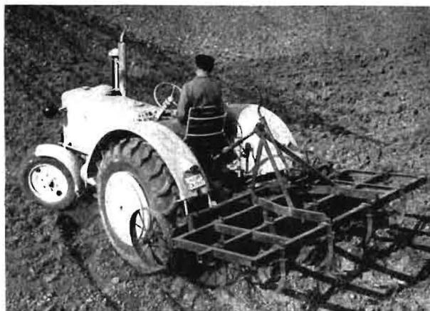
Bild 2. RS Zetor Super mit Anbaukultivator KHN-280 für tiefe Bodenlockerung
