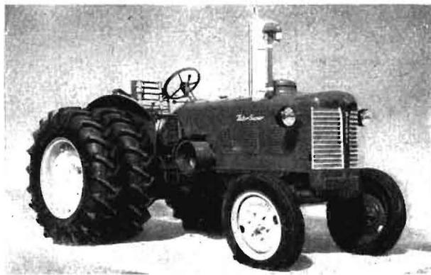
Bild 3. RS Zetor Super mit Zwillingbereifung der Hinterachse
