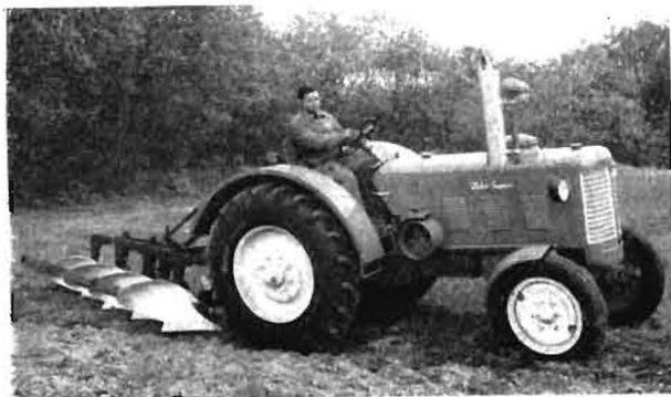
Bild 1. RS Zetor Super mit aufgesatteltem Vierschar-Pflug 4 PN-30
