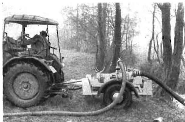
Bild 1. Zapfwellenpumpe; etwa 50 m<sup>3</sup>/h Leistung, 60 m manometrische Förderhöhe, selbstansaugend
