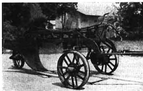
Bild 5. Rigol-Grabenpflug, in der MTS Rožnava entwickelt
