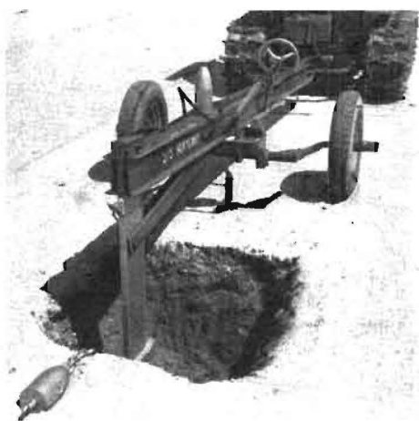
Bild 6. Maulwurfsdränpflug der MTS Rokycany
