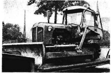
Bild 2. KT 50 als Planier Raupe für die Wegeplanierung
