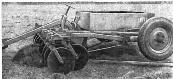
Bild 1. Vom Verfasser konstruierter Grünlandhobel für Traktorzug nach dem Prinzip des Bülltenpfluges von UHLIG, Hohennauen
