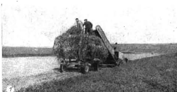
Bild 1. Mähliader E 062 mäht und ladet in einem Arbeitsgang
