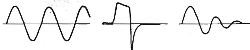
Bild 5. a Wechselstromgerät, b Batteriegerät, c Kondensatorgerät
