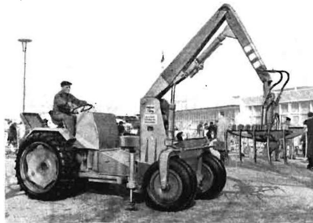
Bild 1. Vollhydraulischer Schwenkkran T 157/1 vom VEB Landmaschinenbau „Rotes Banner“ Döbela, Baukastenkonstruktion zum RS 09
