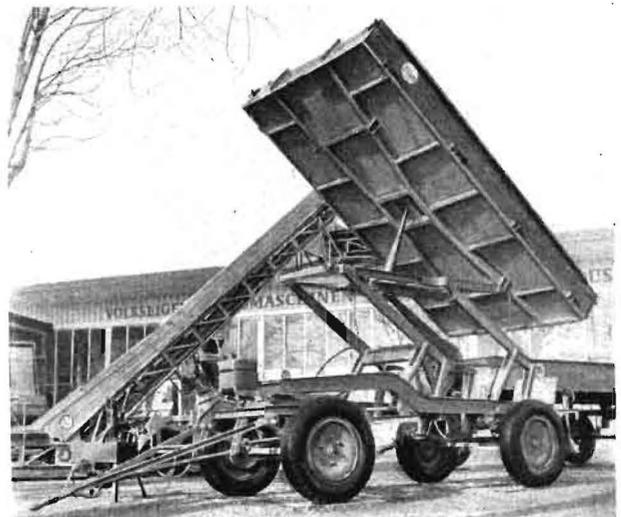
Bild 8. Hochumladekipper T 100 - Neuentwicklung vom VEB Landmaschinenbau Rathenow
