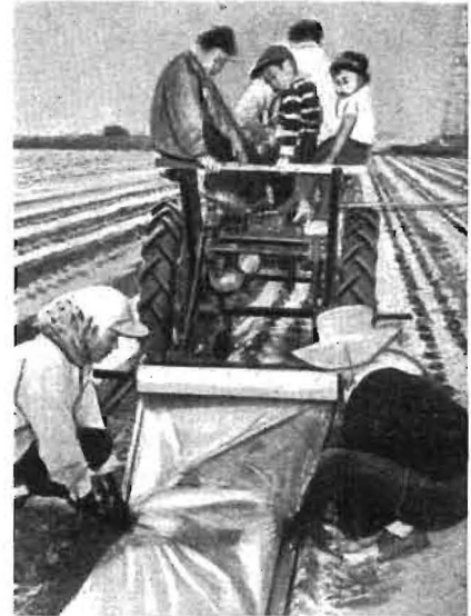
Bild 3. Verlegung von Plastikfolien mittels Schlepper auf einer Erdbeerpflanzung (Foto: Bakelite Co.)
