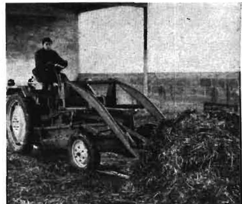
Bild 5. Entmisten im Flachlaufstall: Herausschieben des Dungs mit der Stallarbeitsmaschine
