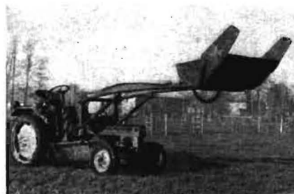
Bild 1. RS 09 mit Frontlader T 150 und Schiebe- und Lademulde (1,80 m AB)
