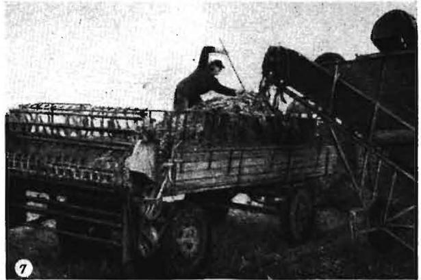
Bild 7. Ein Dungstreuer mit Aufsatzgitter wird mit Silomais beladen
