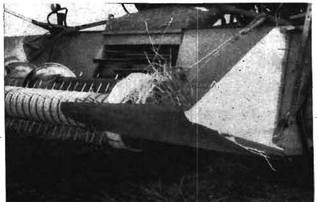
Bild 5. Die freie Schneidwerkseite wurde verkleidet
