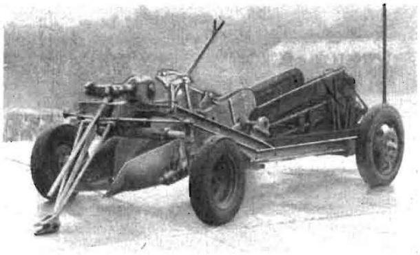
Bild 2. Fahrbarer Siebstand mit Siebkette
