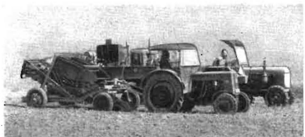
Bild 3. Siebstand und fahrbares Stromaggregat während der Versuchsdurchführung
