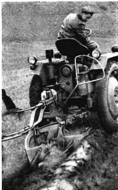
Bild 6. Nicht der Motor, sondern der zu hohe Radschlupf des zu schmalen Reifens war hier der begrenzende Faktor
