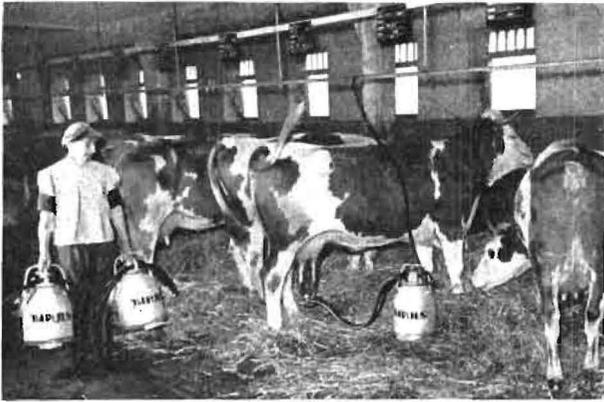
Bild 3. Die Melkanlage „M 55“ bei der Arbeit
