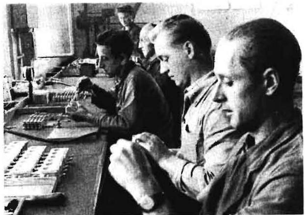
Bild 2. Im Taktverfahren werden die Pulsatoren montiert
