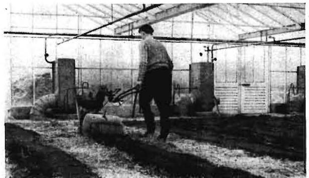
**Bild 6.** Einsatz der Motorfräse zur Bodenbearbeitung im MZG Typ 0/55. Trotz der Firststützen ist eine maschinelle Bodenbearbeitung mit Fräse und Einachsschlepper gut durchführbar
