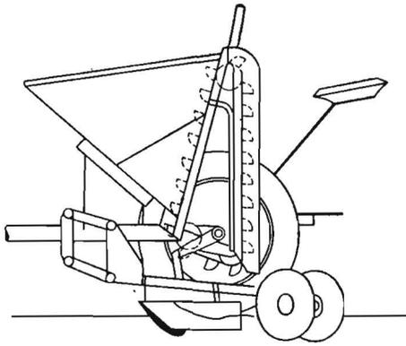
Bild 1. Legemaschine A 950 mit verbessertem Furchenwerkzeug
