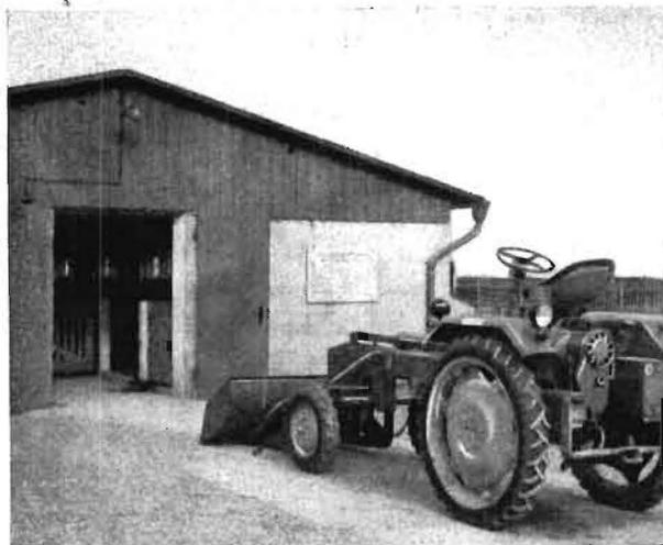
Bild 2. RS 09 mit hydraulischem Schubschild beim Entmisten von Ställen
