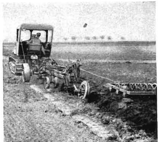
Bild 1. KS 62 mit Anhängerpflug DV 30 bei der Arbeit. Durch richtige Pflugeinstellung wird saubere Furche erzielt ...
