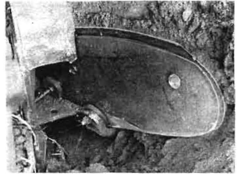
Bild 3 (rechts). Sichtfläche zur Beobachtung des Bodenverhaltens beim Pflügen mit dem Glas-Streichbrett
