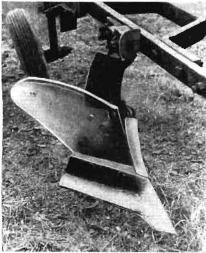
Bild 2 (links). Befestigung von Glas-Streichbrett und Pflugkörper
