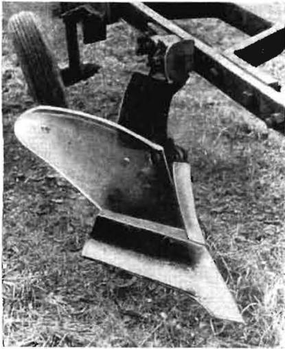
Bild 2 (links). Befestigung von Glas-Streichbrett und Pflugkörper
