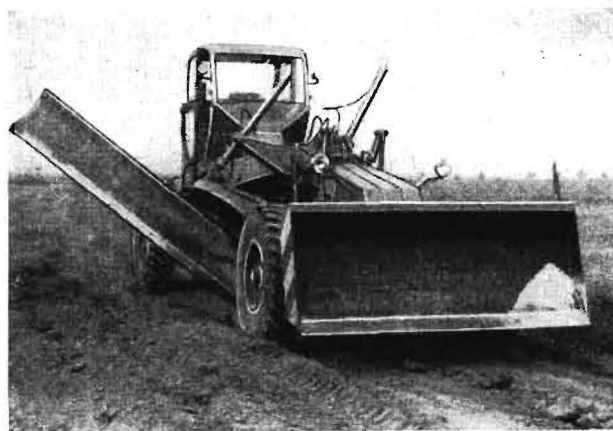
Bild 5. Straßenhobel SHM-4 mit Schareinstellung zum Böschungsschneiden
