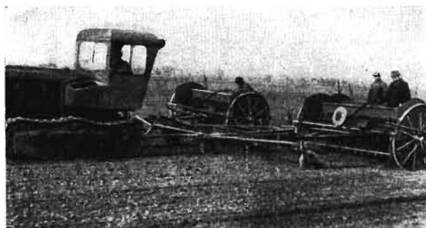
Bild 2. Kopplung von drei Drillmaschinen mit dem Kopplungsbalke Z 102
