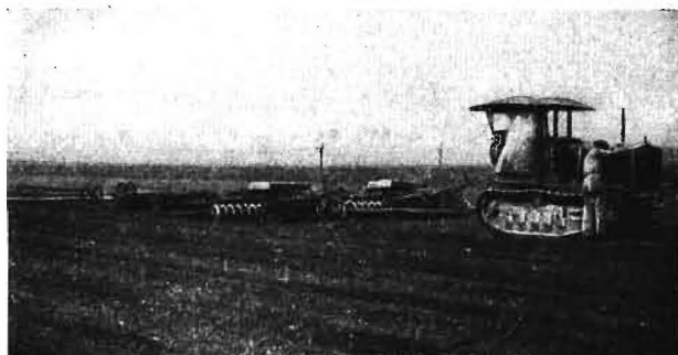
Bild 5. Kopplung gleicher Geräte nebeneinander und verschiedener Gerätesätze hintereinander bei der Saatbettvorbereitung
