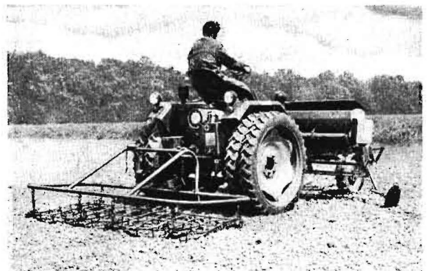
Bild 2. Geräteträger RS 09 mit Anbaudrillmaschine A 188 und Eggenträger mit Saategge in Dreipunktaufhängung
