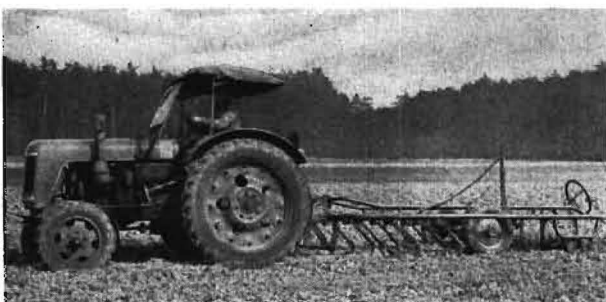
Bild 3. Unsere industriell gefertigte Gerätekombination: der Kombinator K 17/B 806; 1,7 m Arbeitsbreite
