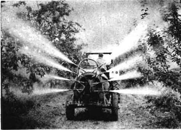
Bild 3. Hochdruckspritze S 050/2 mit Strahlrohrrahmen
