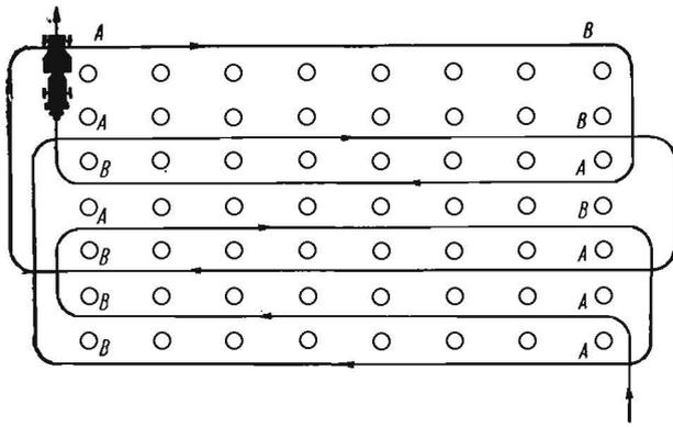
**Bild 9** Schema der Fahr- und Sprühtechnik. Bei A werden die Düsen ein- und bei B ausgeschaltet
