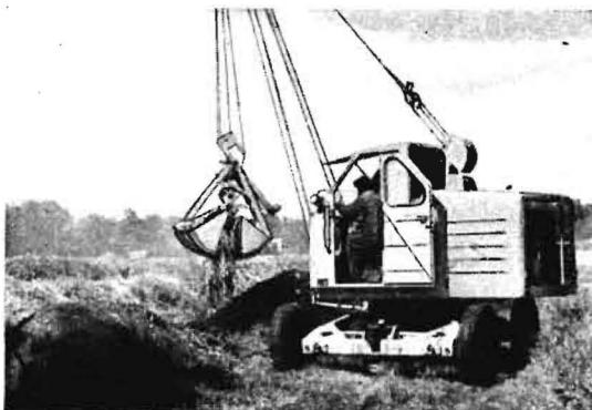
Bild 1. Selbstfahrender Lader T 170 beim Umsetzen von Kompost
