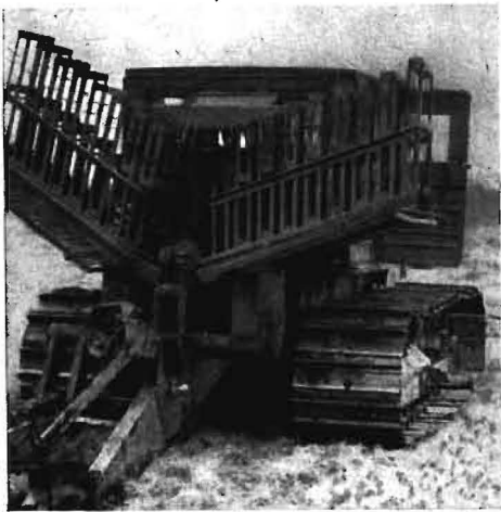
Bild 10. Versuchsmaschine am Traktor S-80 für die Tonrohrverlegung ohne Grabenaushub
