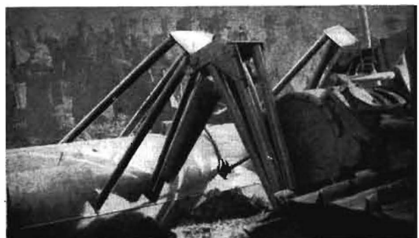
Bild 3. Die Bergstütze wird in wenigen Sekunden durch die Seilwinde in Transportstellung gehoben
