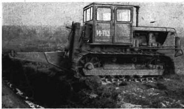
Bild 8. Maulwurfpflug DKG-80 am Traktor S-80
