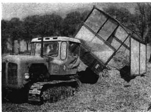
Bild 1. Vom Institut für Landtechnik Potsdam-Bornim aufgebaute Anhänger für Grünfütterhäcksel, Fassungsvermögen 18 m 3
