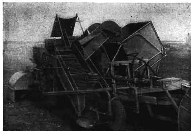
Bild 1. Zweireihige Rübenvollerntemaschine (Pommritzer Prinzip) mit Querschwadablage
