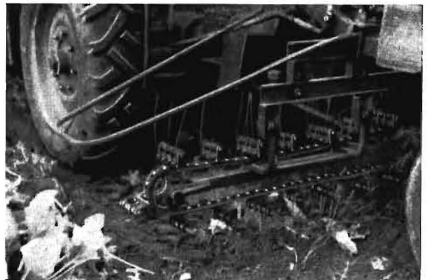
Bild 2. Eine Fegekette wurde zur Beseitigung von Blattresten angebaut
