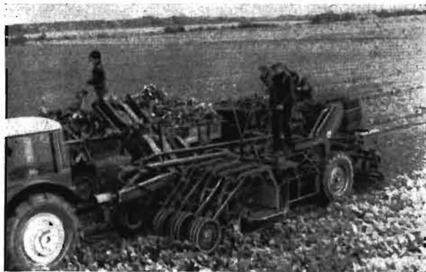
Bild 1 zeigt die umgebaute Maschine E 710 im Einsatz. Der nebenher fahrende Schlepper mit zwei Hängern nimmt auf. Eine Person ist zum Wegpacken auf dem Blatthänger einzusetzen
